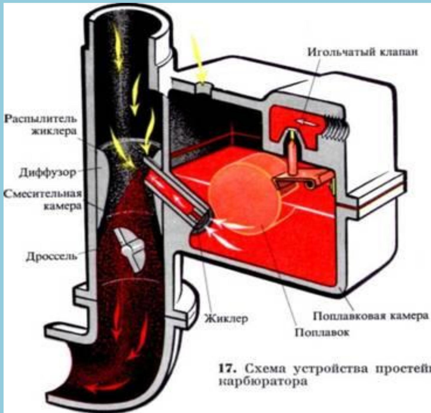
17. Схема устройства простейшего карбюратора
