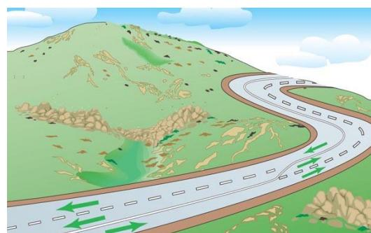
Рис. 4 Чередование количества полос движения в одну сторону
