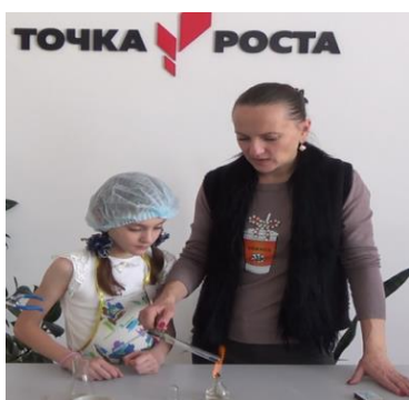
Рисунок 8. Опыт получения кислорода. Нагреваем пробирку, в которой поместили перманганат калия – марганцовку.
